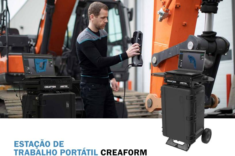
Os atuais ambientes de produção e de campo precisam de soluções de inspeção dimensional portáteis, que ofereçam a mesma precisão, confiabilidade e repetibilidade das tecnologias de medição encontradas nos laboratórios de metrologia. Aproveite ao máximo a portabilidade dos escâneres 3D da Creaform com nossa estação de trabalho portátil para facilitar a digitalização 3D nos chãos de fábrica ou em campo.
