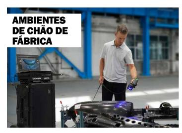
A estação de trabalho portátil da Creaform permite que equipes de controle de qualidade com qualquer nível de habilidade inspecionem as peças em qualquer estágio do processo de produção — inclusive no chão de fábrica. Esta estação de trabalho é uma verdadeira potência, pois facilita enormemente a configuração de um escâner 3D portátil em qualquer ambiente de fabricação e ajuda você a melhorar sua eficiência e desempenho no controle de qualidade.
