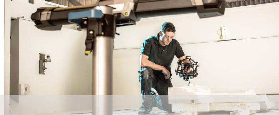
Libéré de tout montage de mesure rigide, le **scanner MetraSCAN 3D<sup>MC</sup> sur MMT optique** propose une précision de mesure en usine insensible aux instabilités de l'environnement. Grâce à son volume de mesure extensible, sa vitesse incroyable et une efficacité impressionnante d'acquisition des données avec des matériaux complexes, il s'agit du scanner 3D de qualité métrologique le plus complet du marché et d'une alternative viable aux MMT portables traditionnelles.
