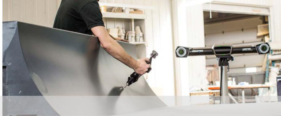
La **MMT optique portable HandyPROBE Next<sup>MC</sup>** propose une exactitude de mesure insensible aux instabilités de l'environnement. Libérés de tout montage de mesure rigide, la pièce, le capteur optique et le palpeur sans fil peuvent être déplacés à tout moment durant la séquence de mesure. Conçu spécialement pour une utilisation en usine, le système propose une flexibilité unique et un volume de mesure plus important que les autres MMT portables.
