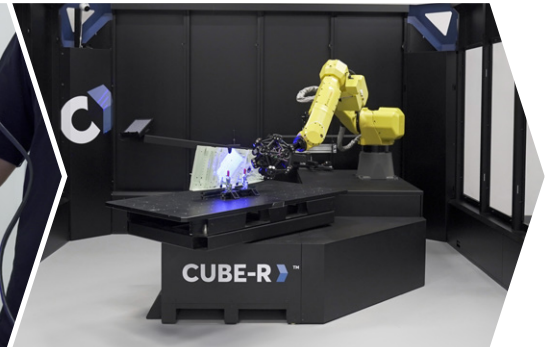
Dedizierte automatisierte Qualitätskontrolle Genau, schneller, aber weniger flexibel, da Tragbarkeit geringer ist
