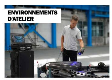
La station de travail portable de Creaform permet aux équipes de contrôle de la qualité, de tous niveaux, d'inspecter des pièces à toutes les étapes du processus de production, directement dans l'atelier. Facilitant grandement la configuration d'un scanner 3D portable n'importe où dans un environnement de fabrication, cette station de travail est un élément essentiel pour vous aider à améliorer l'efficacité et les performances du contrôle de la qualité.
