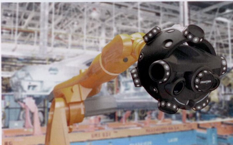
Robotergeführte Scannlösung für automatische Inspektion.
