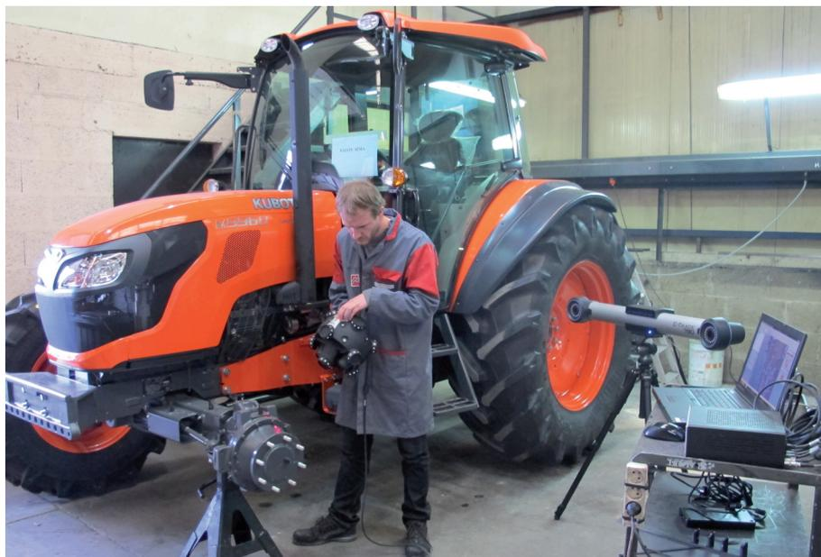
MX utilise dorénavant les technologies de Creaform pour exécuter les tâches de numérisation du tracteur, notamment le balayage de l'intégralité des zones nécessaire à la conception des bâtis d'adaptation.
