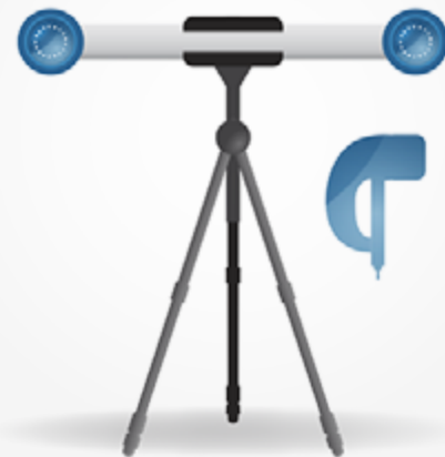
MIT DER TRAGBAREN OPTISCHEN CMM HANDYPROBE
